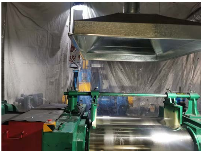
密炼机上方集气罩及封闭设置情况
