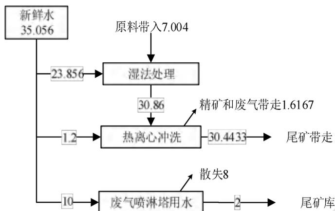
图 2-1 环评时水平衡图 (单位: m³/a)
