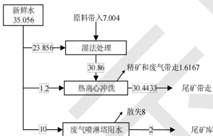
图 2-2 验收时水平衡图 (单位: m³/a)
