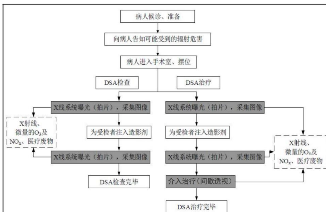
图2-5 DSA 工作流程及产污环节示意图
