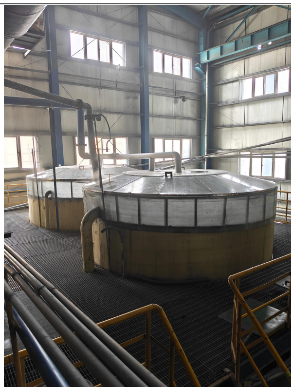
浮选柱废气密闭收集
