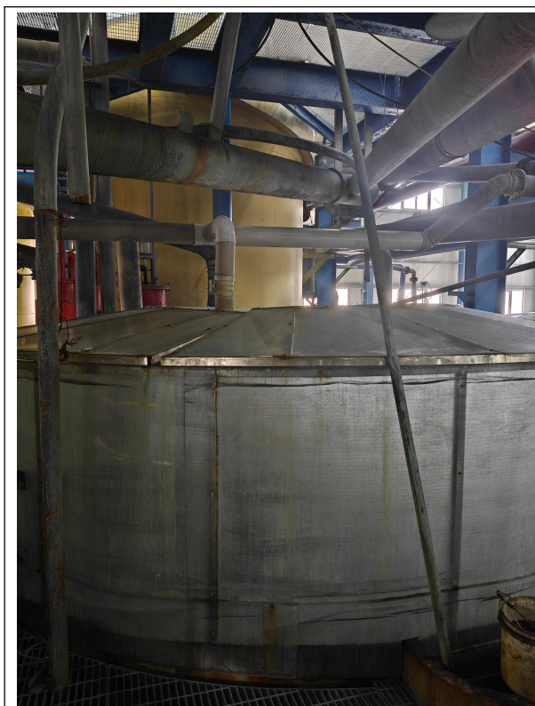
浮选柱废气密闭收集
