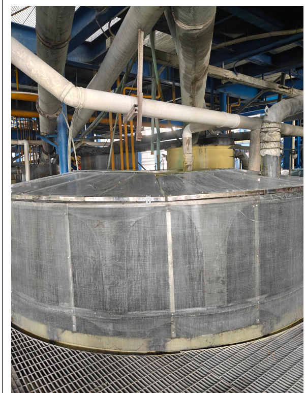
浮选柱废气密闭收集
