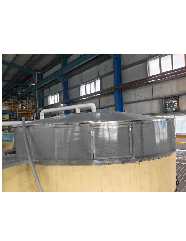
浮选柱废气密闭收集
